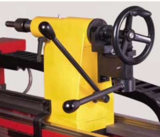
Reitstock-Schnellspannung quick loading device Serrage rapide a excentrique
