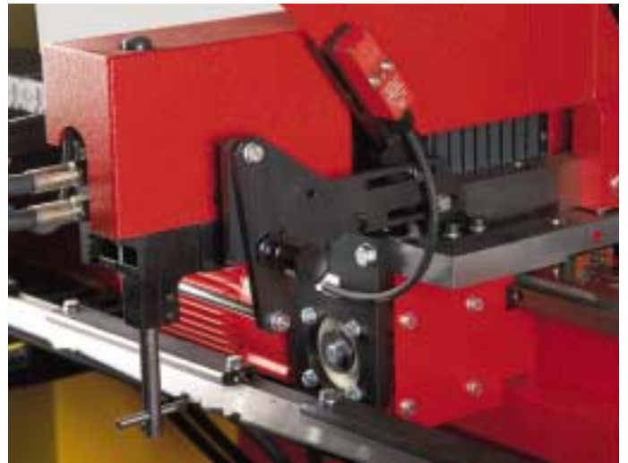
Revolver-Tiefeneinstellung multi step depth device Revolver pour réglage en profondeur
