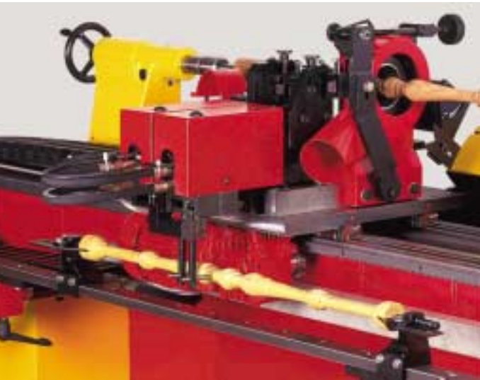
Profilabtastung vom Muster copying from original copiage sur modèle
