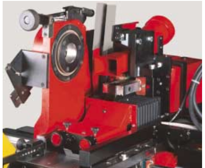
2 Kopierschlitten für große Zerspanung Absaughaube für Kopierschlitten 2 copy carriages for large cutting operations extraction for copy carriage 2 Supports de copiage pour prise de bois importante Bouche d'aspiration pour support de copiage
