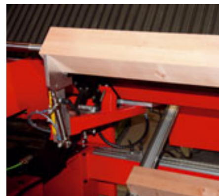
Magazin für Vierkantholz 30x30 bis 100x100 mm, Einlegelänge von 200 – 1600 mm Magazine for squared timber: 30x30 to 100x100 mm, Insert length: 200 – 1600 mm Magasin pour bois équarri 30x30 à 100x100 mm Longueur d'insertion de 200 à 1600 mm
