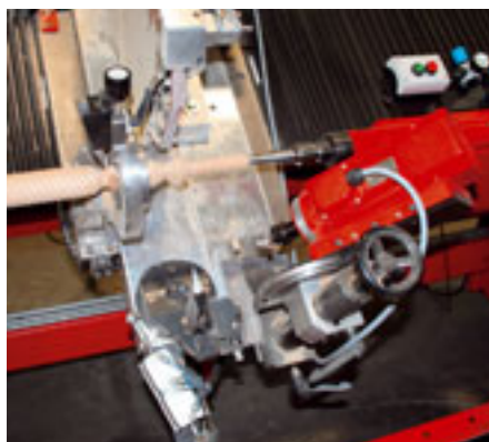
Fräsgerät höhenverstellbar und schwenkbar Milling unit, adjustable in height and swivelable Outil de fraisage à hauteur variable et orientable
